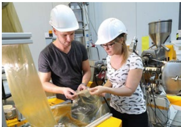
Die PE-Rezyklate können wieder zu neuen Folien verarbeitet werden.
