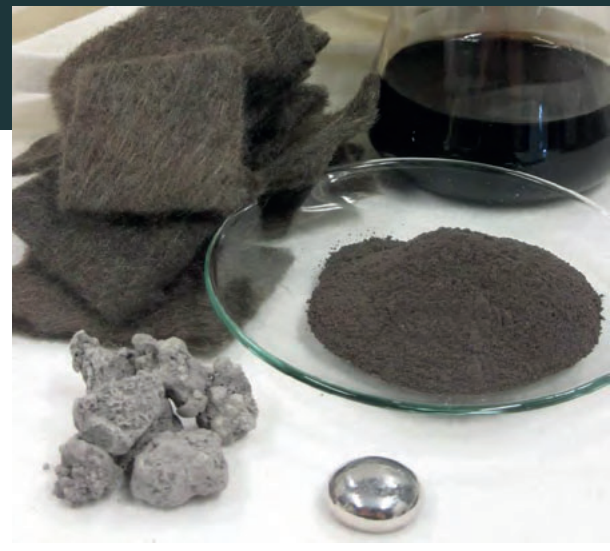
Filter-Fasern für wertvolle Metalle: Das Adsorbentextil nimmt Palladium auf, das anschließend wiederverwertet werden kann.
